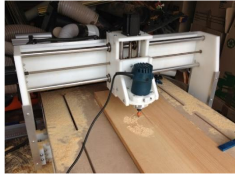
شكل (2) ماكينة التقطيع CNC
